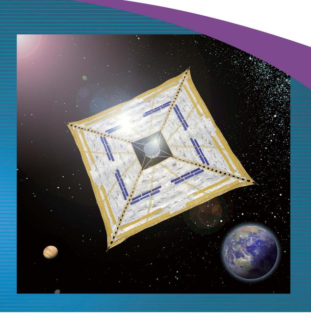
ソーラーセイルは、超薄膜の帆を広げ太陽光圧を受けて進む宇宙船です。ソーラー電力セイルは、帆の一部に薄膜の太陽電池を貼り付けて大電力発電を同時に行います。この電力を用いて高性能イオンエンジンを駆動することで、ハイブリッド推進を実現し、効率的で柔軟なミッションが可能となります。
