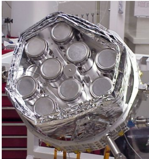
図 2.8 RHESSI に搭載されているスペクトロメーター。9 個のゲルマニウム検出器から成り、0.003–17 MeV のエネルギー範囲に感度を持っている。GRB021206 の偏光観測では 80 \pm 20 [%] の偏光を検出したが、検出器の配置が幾何学的に対称ではなく、得られたデータが衛星の回転周期と同期していることなどから、有意な観測ではないと考えられている。
