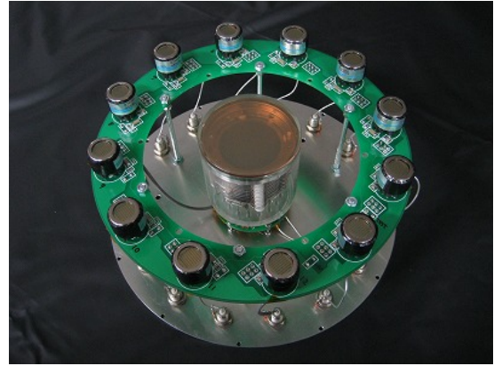
図 4.15 新しく設計したプリント基板と PMT
