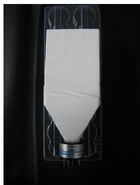
図 4.10 ライトガイドを使用した場合。CsI(Tl) とライトガイドを接合し、ライトガイドと PMT の光電面を接着した状態。CsI(Tl) とライトガイド全体にテフロンテープを巻いている。
