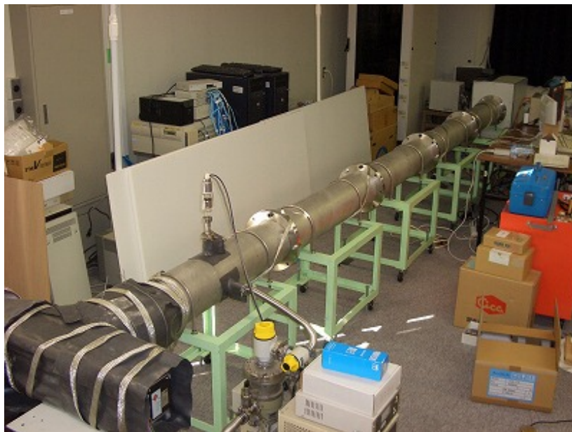
図 5.3 X線発生装置とビームライン。手前に X線発生装置があり、5 m のビームラインを通して奥に検出器のマウント部分がある。ビームラインの内部は鉛が巻かれており、安全に実験を行うことができる。
