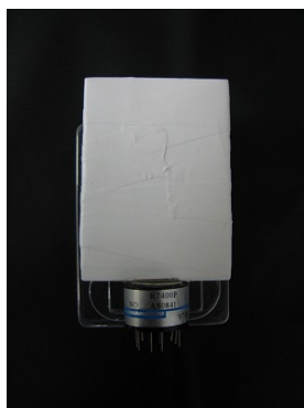
図 4.11 ライトガイドを使用しない場合。板状の CsI(Tl) と PMT の光電面を接着した状態。CsI(Tl) の底面で PMT と接触していない部分はテフロンテープを巻いている。
