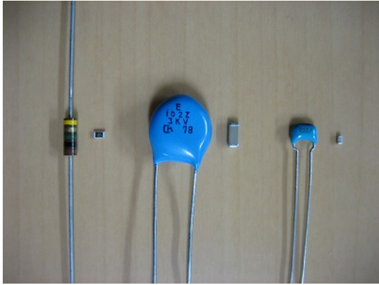
図 4.14 通常の部品と表面実装部品
