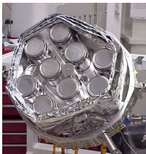
図 2.9 RHESSI に搭載されているスペクトロメーター。9 個のゲルマニウム検出器からなり 3\text{ keV} - 20\text{ MeV} のエネルギーに感度を持つ。
