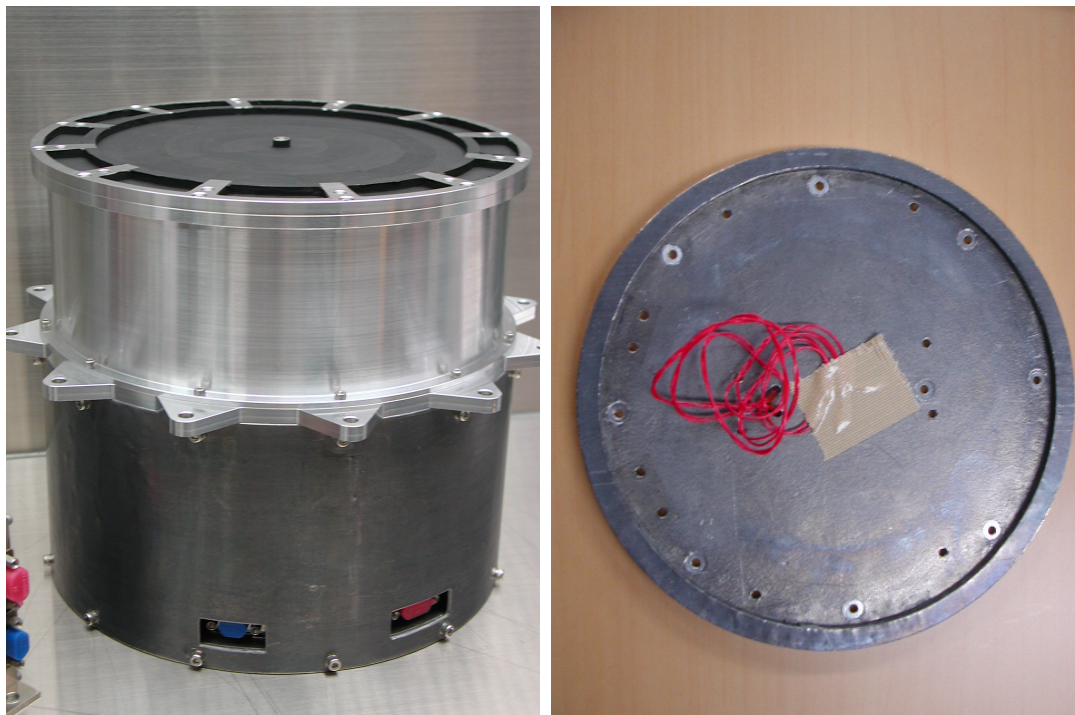
図 5.18 左：側面の鉛シールド。上部はアルミケースの内部にある。右：底板の鉛シールド。上筒と底面の鉛シールドは 0.5 mm、下筒の鉛シールドは 0.3 mm である。
