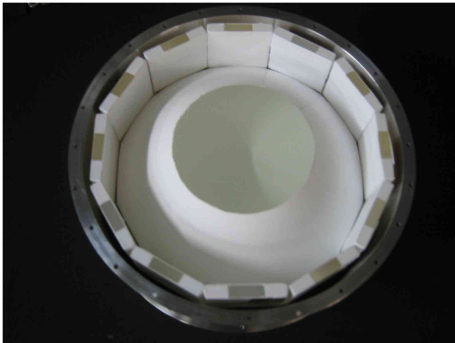
図 5.4 プラスチックシンチレータと CsI シンチレータを一体化し、アルミケース内に格納した様子。
