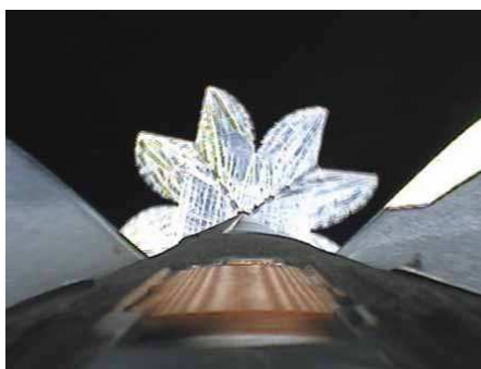
図 4.2: 宇宙空間でのソーラーセイル展開実験。S-310 ロケットにより高度 150 km の弾道軌道上で大きさ 10 m のセイル展開に世界で初めて成功した。
