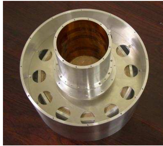
図 7.4: 作成した検出器ケースにシンチレータを組み込んだ様子
