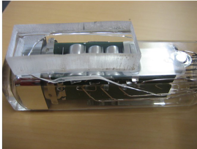
図 4.8 プラスチックとガラスを BC-600 で接着したサンプルの温度変化後。BC-600 が熱歪みを吸収できないため、ガラスに力が加わり、ガラスを割ってしまった。
