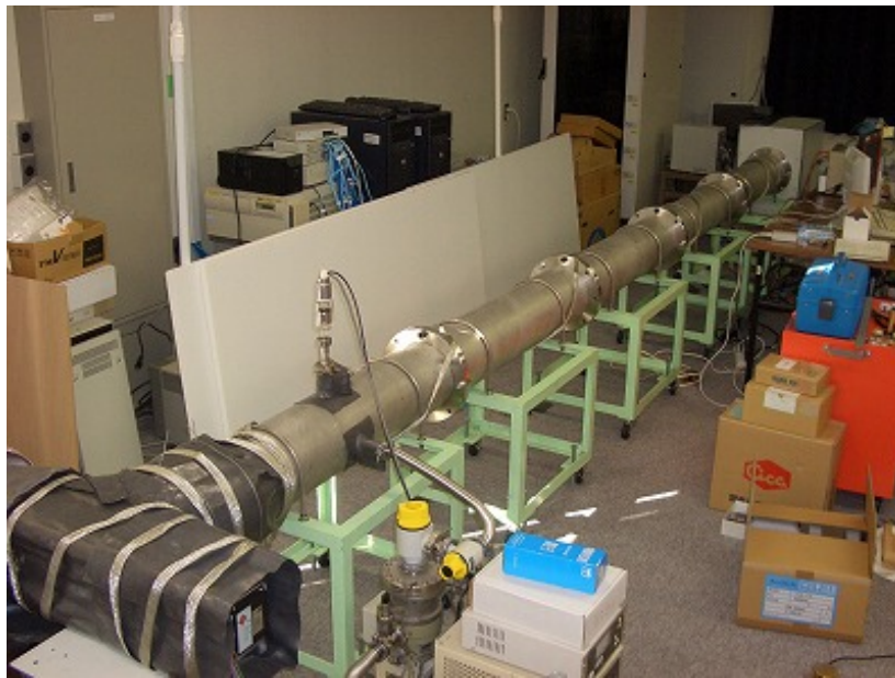
図 5.5 X 線発生装置とビームライン。手前に X 線発生装置があり、5 m のビームラインを通して奥に検出器のマウント部分がある。ビームラインの内部は鉛が巻かれており、安全に実験を行うことができる。
