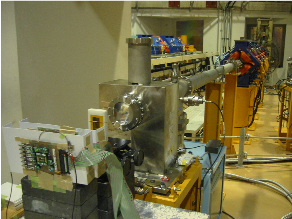
図 6.7 放射線医学総合研究所でのプロトン照射試験の様子。ビームラインの手前に GAP で使用される予定の半導体素子を並べ半導体素子全面にプロトンを照射する。
