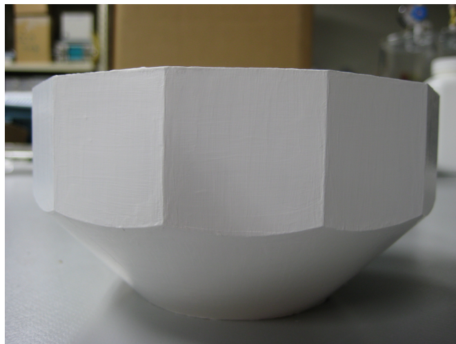
図 4.7 BC-620 を塗布したプラスチックシンチレータ。プラスチックシンチレータは複雑な形状をしておりバルカテープを巻きにくいいため同程度の性能を持つと考えられる、BC620 を塗布した。
