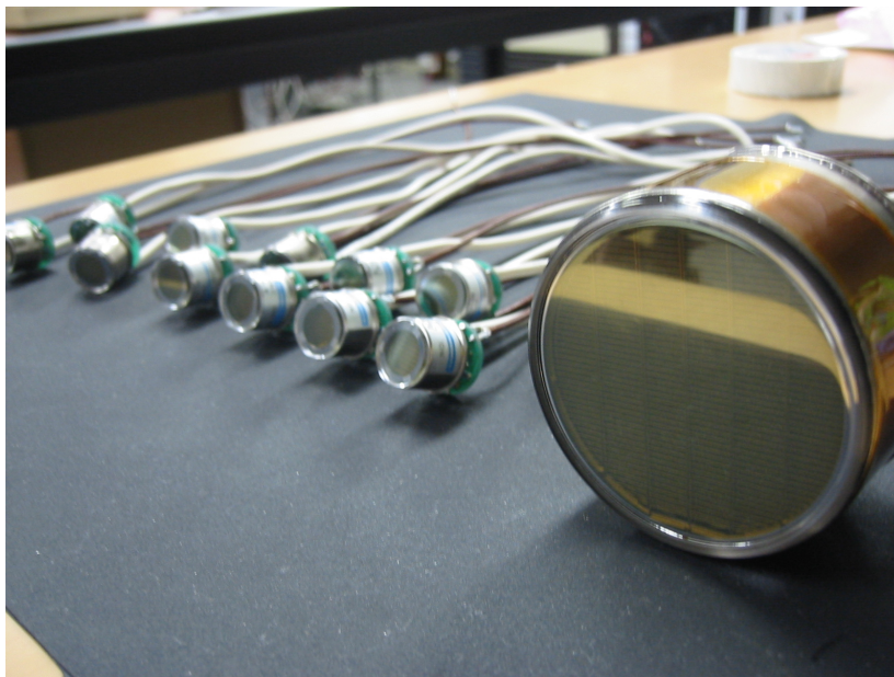
図 4.9 CsI 用光電子増倍管 R7400U(左)、プラスチック用光電子増倍管 R6041(右)。R6041 は、同じ光電面の大きさを持つ、PMT に対して小型であり、耐震化してある。光電面はスーパーバイアルカリ加工が施してあり、検出限界エネルギーを低くできる。
