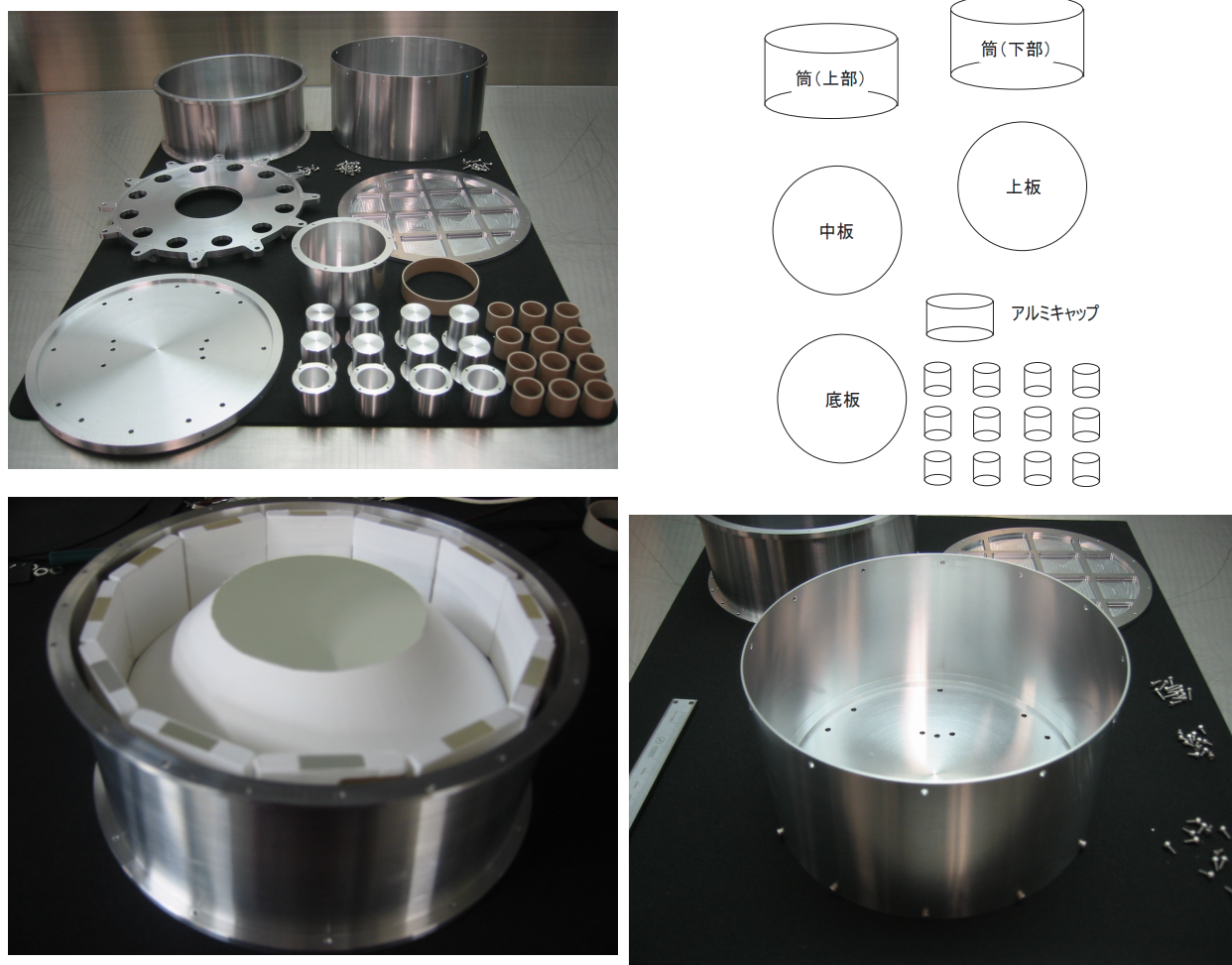
図 4.20 シンチレータ、PMT を収納するアルミケース。左上図は右上図と対応している。上板、筒（上部）を使って、左下図のようにシンチレータを収納する部分を作る。底板、筒（下部）を使って、右下図のような回路を収納する部分を作る。この二つの部分は中板を挿んで一体化され、中板には衛星取り付け用の突起部分がある。アルミキャップは光電子増倍管を収納し、中板に取り付ける。
