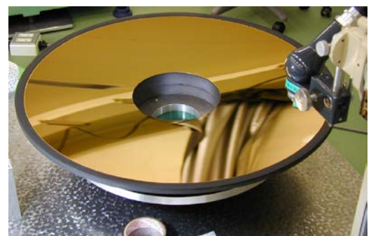
図 1 2. あかり衛星の主鏡(直径 70cm)
